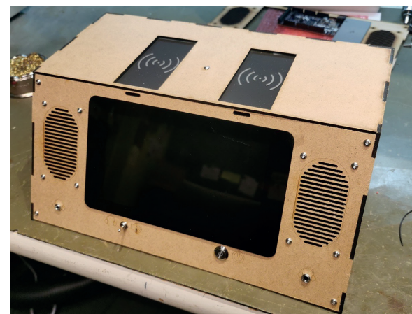
Figure 1. Pupitre CoMo Rééducation – Sonification du mouvement par le geste. Recharge par induction, haut-parleurs, écran tactile.
