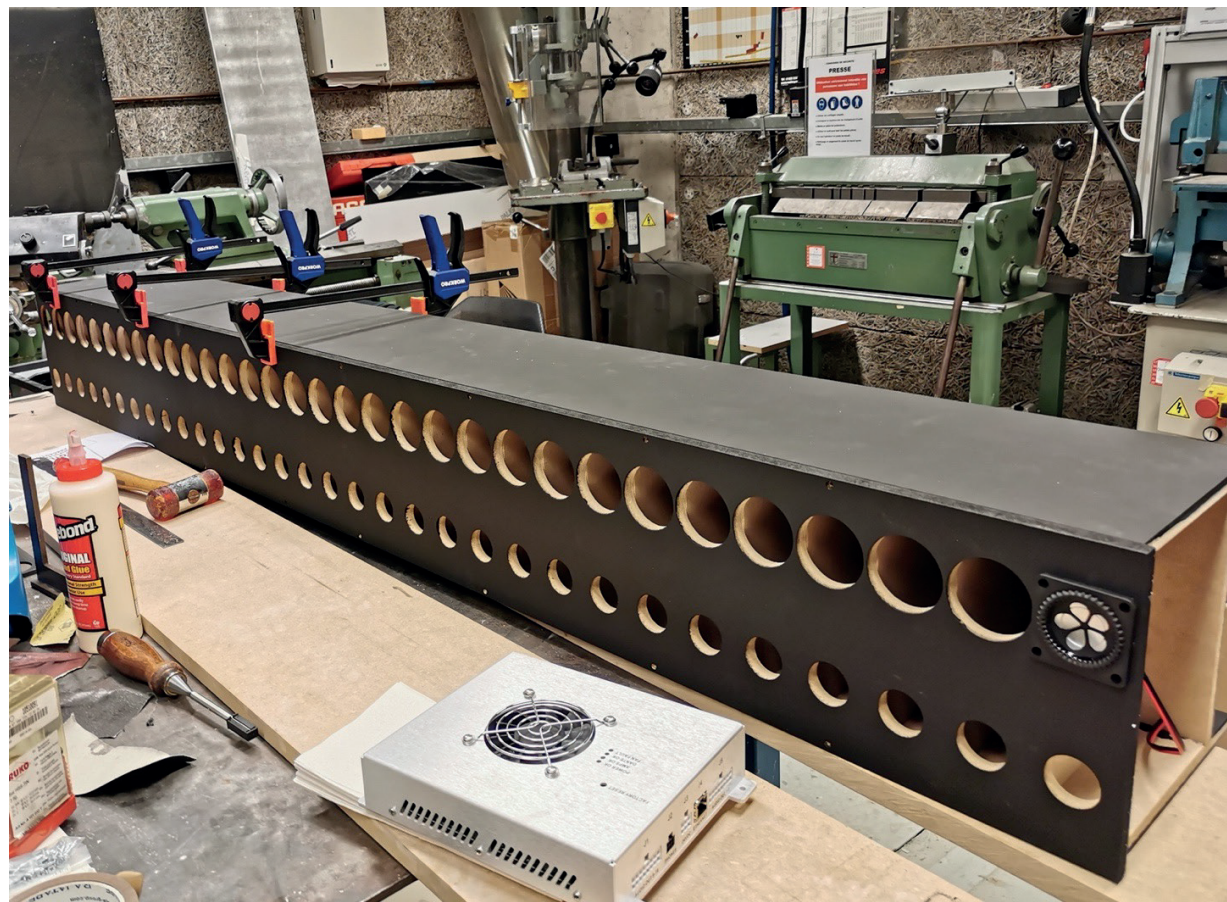
Figure 4. Enceinte WFS 32 canaux en construction – GASP – EAC.
