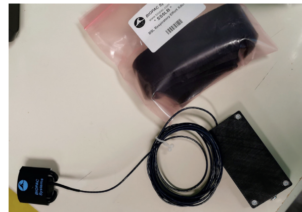
Figure 6. Capteur de respiration et d'attitude pour l'analyse corporelle en temps réel du pianiste (R-IoT) – Production en série – Heart.FM.
